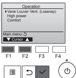
Sélectionnez "Vane-Louver-Vent. (Lossnay)" (Ailette-Évent-Vent. (Lossnay)) dans le menu Operation (Fonctionnement) et appuyez sur la touche [CHOIX].
