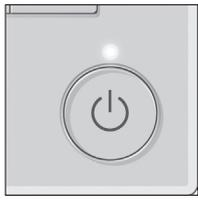
Pressez la touche [MARCHE / ARRÊT]. La lampe MARCHE / ARRÊT s'allume en vert, et l'appareil démarre. Lorsque "LED lighting" (Éclairage LED) est réglé sur "No" (Non), le témoin ON/OFF ne s'allumera pas.
