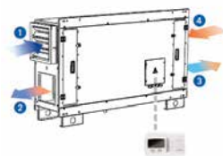
VERSION VR Unité verticale, Inspections à droite
