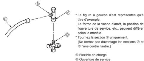
\* La figure à gauche n'est représentée qu'à titre d'exemple. La forme de la vanne d'arrêt, la position de l'ouverture de service, etc., peuvent différer selon le modèle.
