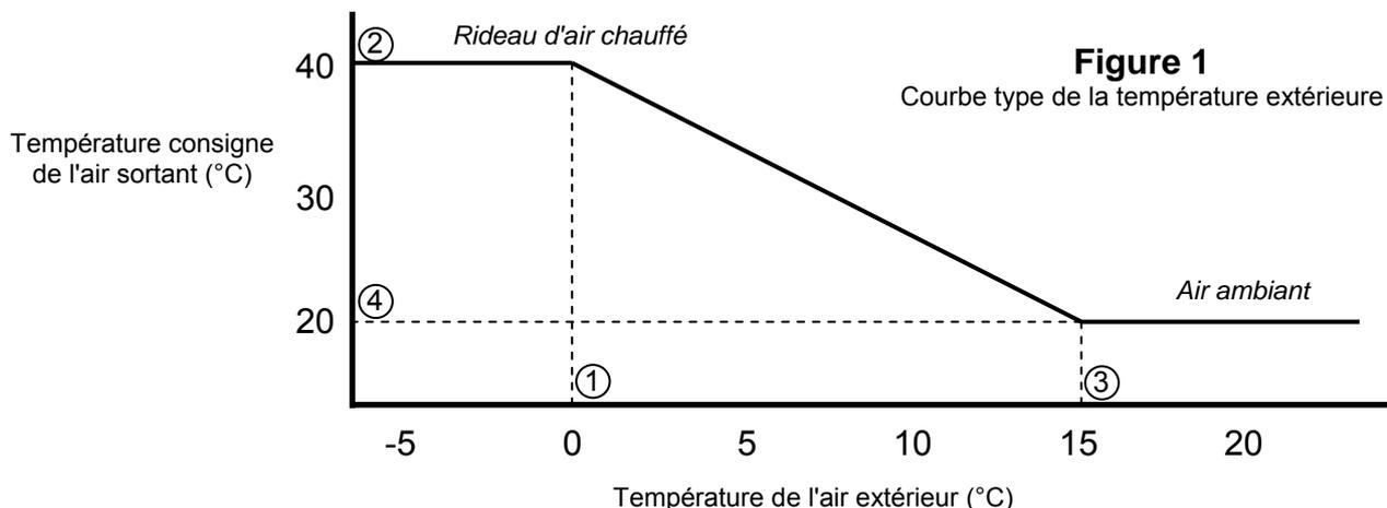
**Commande de température de soufflage (CHAUD):** Dans ce mode, l'utilisateur règle la température désirée (35°C par exemple) et le rideau d'air commande la température de l'air sortant de sorte qu'il demeure à 35°C même si la température de l'air entrant change.
