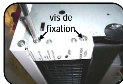
Abaisser soigneusement le côté gauche de la grille de sortie, en supportant son poids par le dessous. On peut maintenant accéder à la carte d'indicateur de filtre et changer la position du cavalier.
