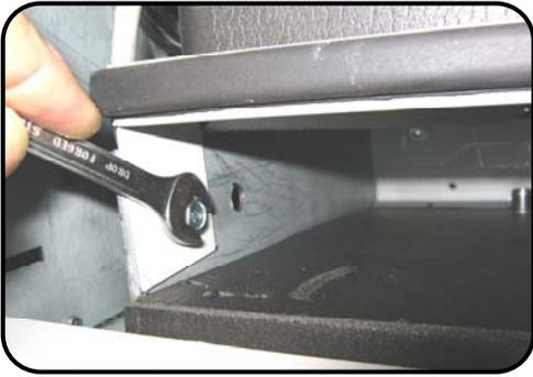
A l'aide d'une clé de 10 mm, desserrer les deux boulons de chaque côté de la sortie d'air, en faisant 2 tours. Ne pas défaire complètement les deux boulons.
