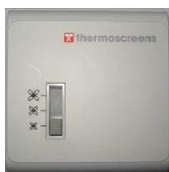
Si l'utilisateur souhaite télécommander la vitesse de ventilation. **NB** la norme industrielle consiste à commander la grande/petite vitesse de ventilation au moyen d'un contact sur de porte ou une seule vitesse définie lors de la mise en service
