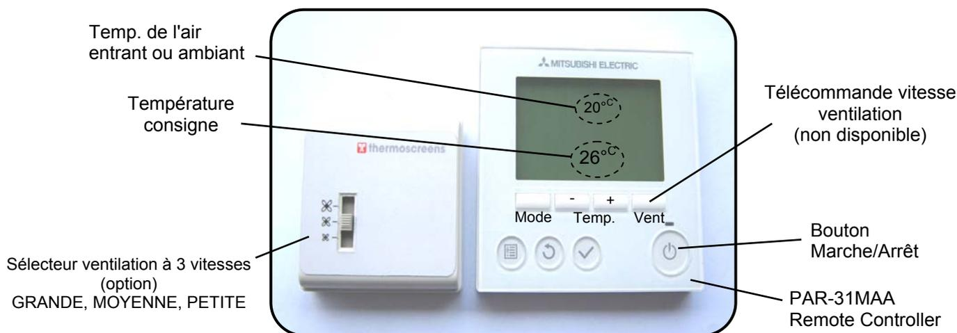
Éteindre le rideau d'air en utilisant le bouton Marche/Arrêt situé sur la télécommande PAR-31MAA. Les ventilateurs du rideau d'air s'arrêteront dans les secondes qui suivent. Si le mot **Chaud Dégivre** est sur l'écran, ne pas éteindre, attendre 3 minutes après que le dégivrage soit terminé.
