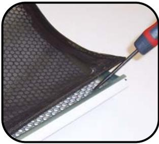
Déposer les filtres des grilles d'entrée d'air en tirant soigneusement pour les dégager comme illustré ci-contre. Avec un aspirateur, dépoussiérer puis reposer les filtres sur les grilles d'entrée d'air. Les filtres sont extrêmement robustes mais il est possible qu'il soit nécessaire de les remplacer après plusieurs révisions.
