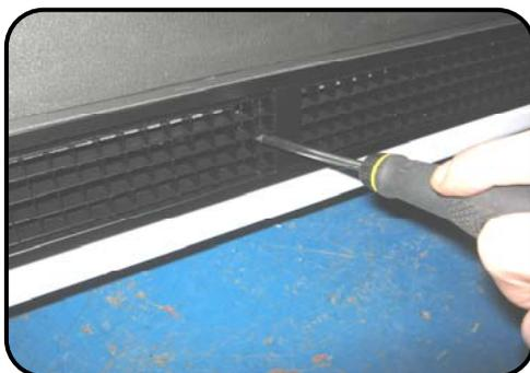
Sur les rideaux d'air HP1500 DXE et HP2000 DXE une vis supplémentaire est prévue au centre de la grille et doit également être déposée.
