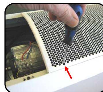
Pour enlever le panneau d'accès inférieur, dévisser les vis de fixation du panneau (une à chaque extrémité et deux au centre, modèles HP1500 DXE et HP2000 DXE), puis glisser le panneau vers l'avant (voir photo ci-contre)
