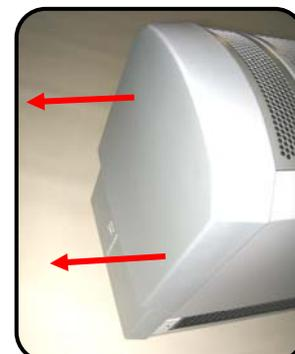
Ensuite, déposer chaque grille d'entrée d'air avec son filtre, en dévissant la vis cruciforme située dans le coin inférieur de chaque grille. Utiliser un tournevis n°1 pour accéder à la vis par l'orifice allongé prévu dans chaque coin inférieur de la grille et le tourner dans le sens horaire pour déposer la vis (voir photo ci-contre).
