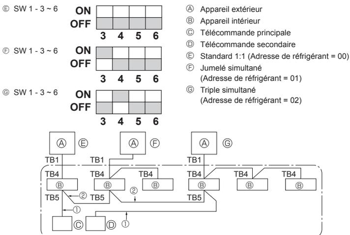
\* Régler l'adresse de réfrigérant avec le commutateur DIP de l'appareil extérieur.
