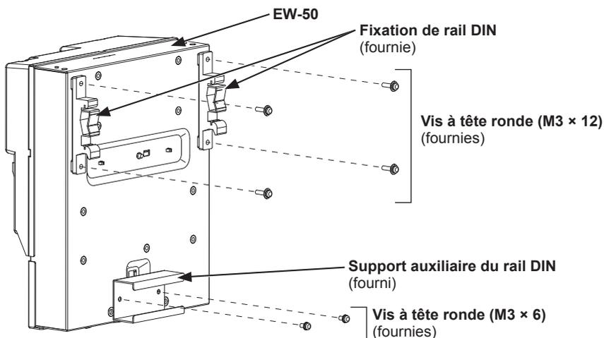
4. Montez le rail DIN (non fourni) sur le boîtier de commande en métal.
