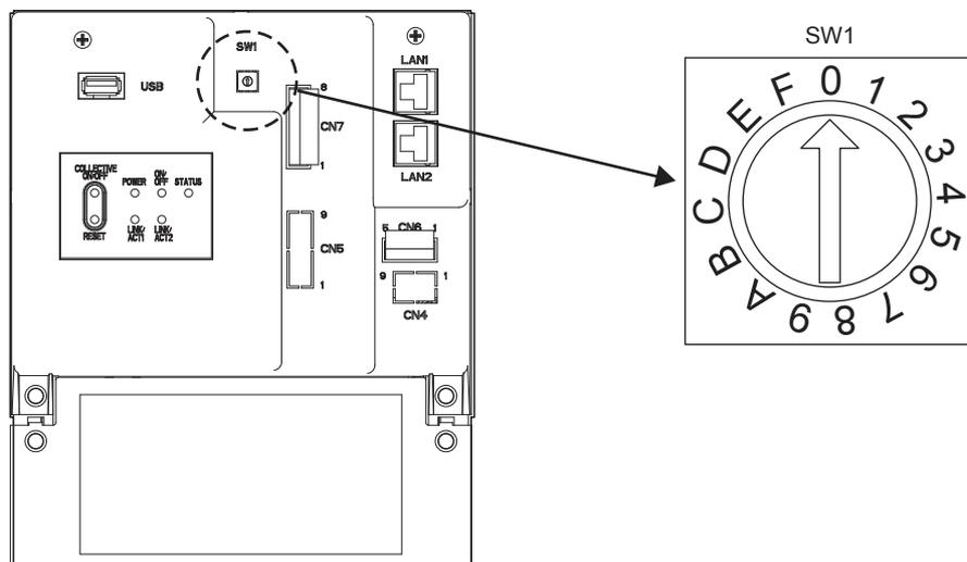
\* La flèche sur le commutateur rotatif indique le réglage actuel du commutateur. Pointez la flèche sur le numéro souhaité.
