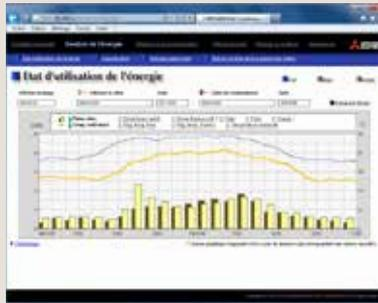
Il est possible de comparer les consommations électriques et les températures ambiantes et de consigne d'une année sur l'autre ou d'un mois à l'autre pour avoir des références de comparaison. Grâce à l' EW-50E, identifiez facilement les défauts d'exploitation.
