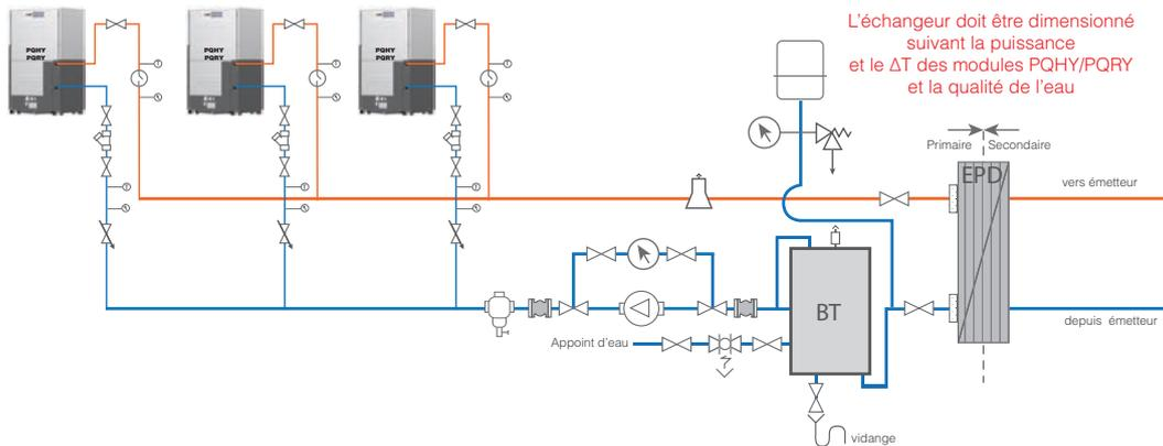
Sur boucle d'eau avec bouteille de découplage avec un circulateur par module
