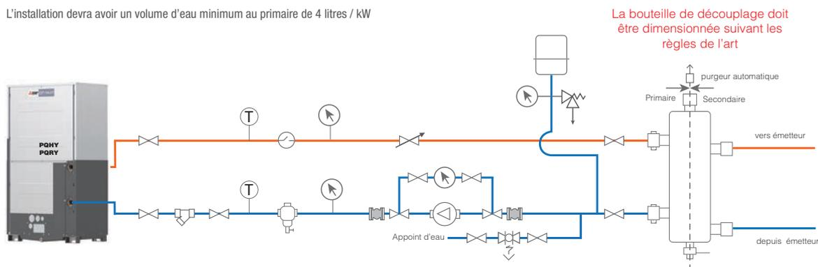
La bouteille de découplage doit être dimensionnée suivant les règles de l'art
