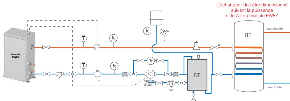
Avec échangeur à plaques et circulateur à débit fixe
