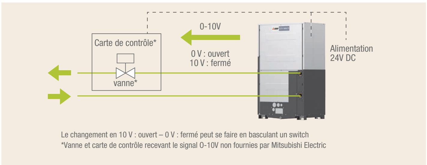
La vanne motorisée doit être sélectionnée selon la plage de débit d'eau du module PQHY / PQRY.
